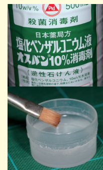
オスバン液を加えたエタノールを筆でぬってカビを除去
