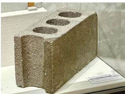
写真2 砂と小石とセメントを混ぜてつくった コンクリートブロック
