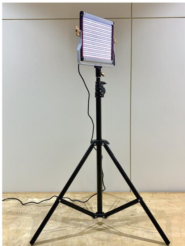
図4 LEDを平面状に並べた照明機材の例
