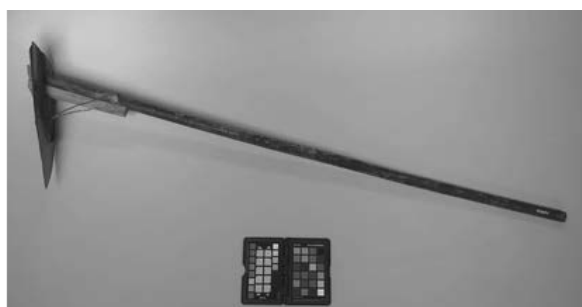
破断・薄化・欠失領域の強化処理（鋤先金属部）
