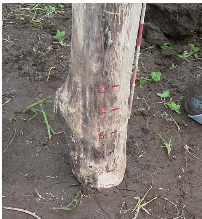
(5) 先端から5cm単位で目印を記入 (10数cm打ち込まれた段階)
