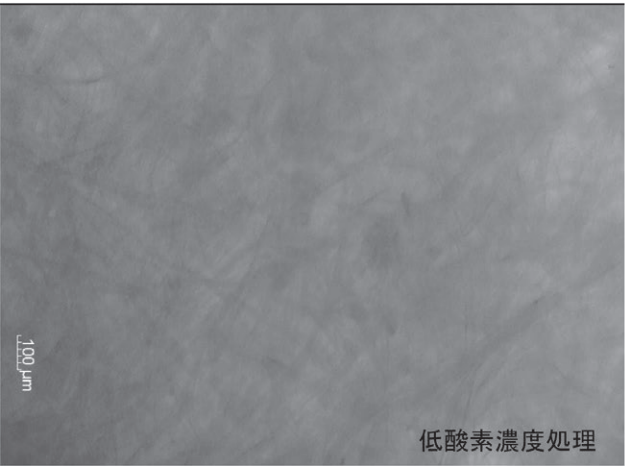
写真3 糸状菌汚染紙試料表面の実体顕微鏡観察画像
