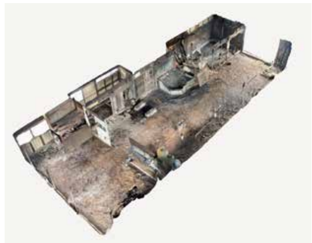
図2 解体直前の明珍鉄工所 内部3Dスキャン
