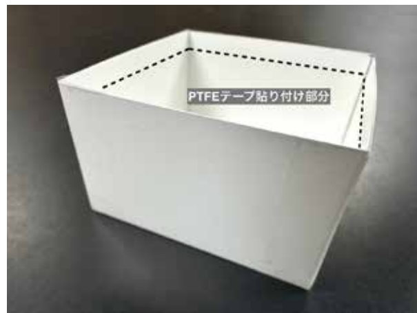
図15 フォト光沢紙で作製した箱 (図中の破線はPTFEテープの境目を示す)
