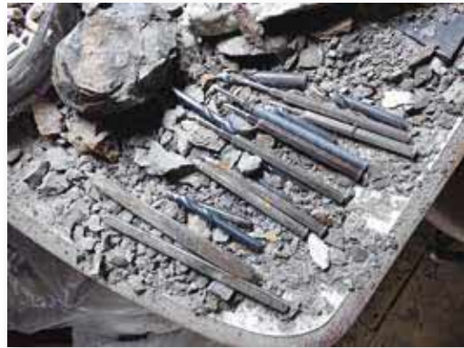
化石のまわりの石を取り除く作業 (クリーニング) で使う道具
